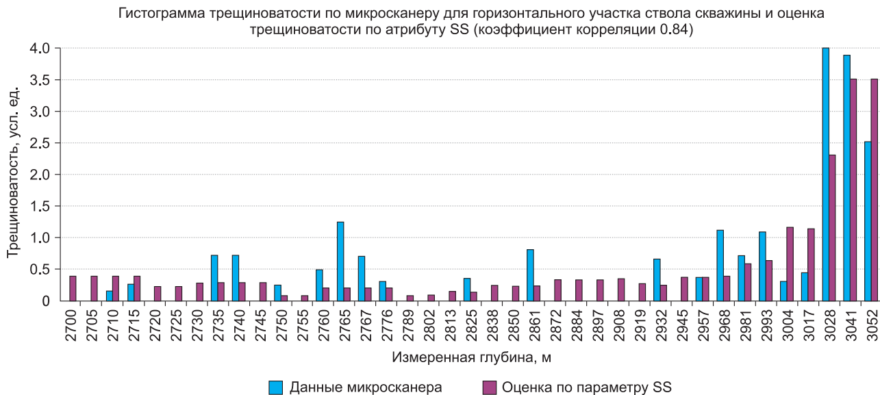
Рис. 1. Результаты количественного сопоставления прогноза трещиноватости по атрибуту SS со скважинными измерениями.
